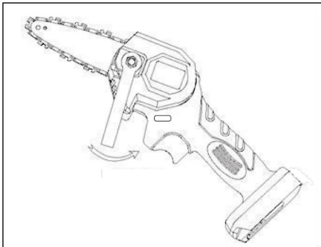
Рис. 1. Откручивание крепежного винта шины
