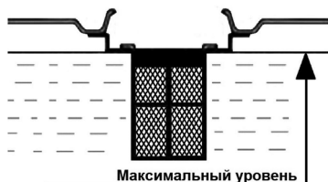
Рис. 9. Максимальный уровень топлива в топливном баке
