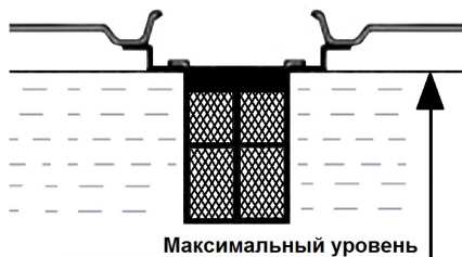
Рис. 10 Максимальный уровень топлива в топливном баке
