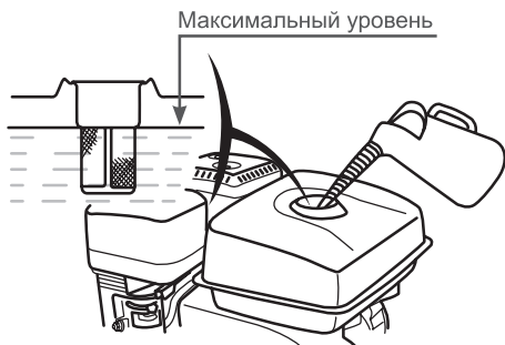
Рис. 9. Максимальный уровень топлива в топливном баке
