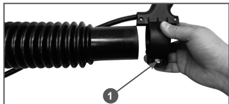
Рис. 4 Установка рукоятки управления
