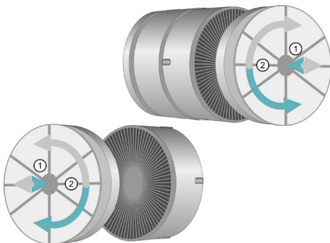
Рис. 14 Установка угольного фильтра
