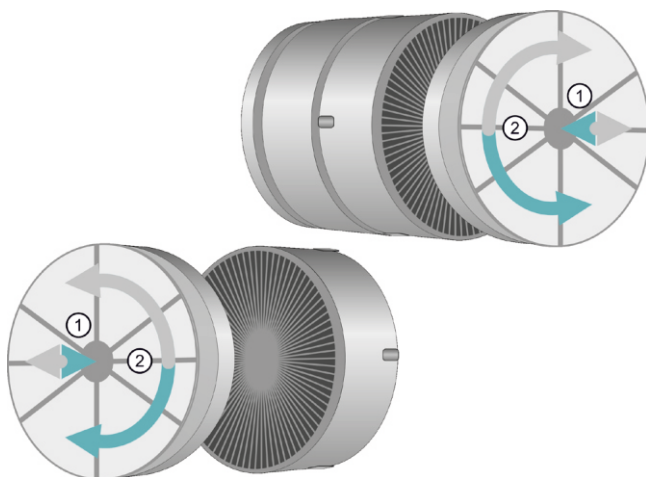
Рис. 14 Установка угольного фильтра
