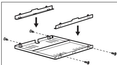
W przypadku zastosowania kasety ochronnej (wyposażenie dodatkowe<sup>1)</sup>) nie jest konieczne zastosowanie osłony bezpośrednio pod urządzeniem.
