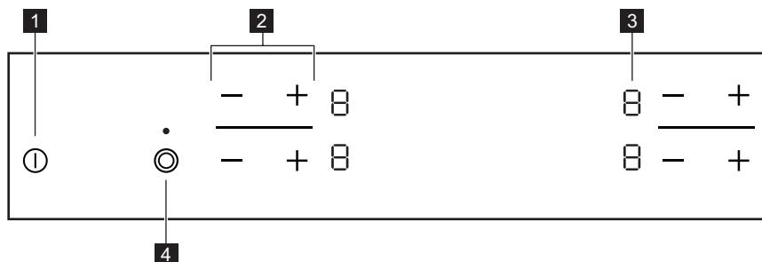
Управление прибором осуществляется с помощью сенсорных полей. Работа функций подтверждается выводом информации на дисплей, а также визуальной индикацией.
