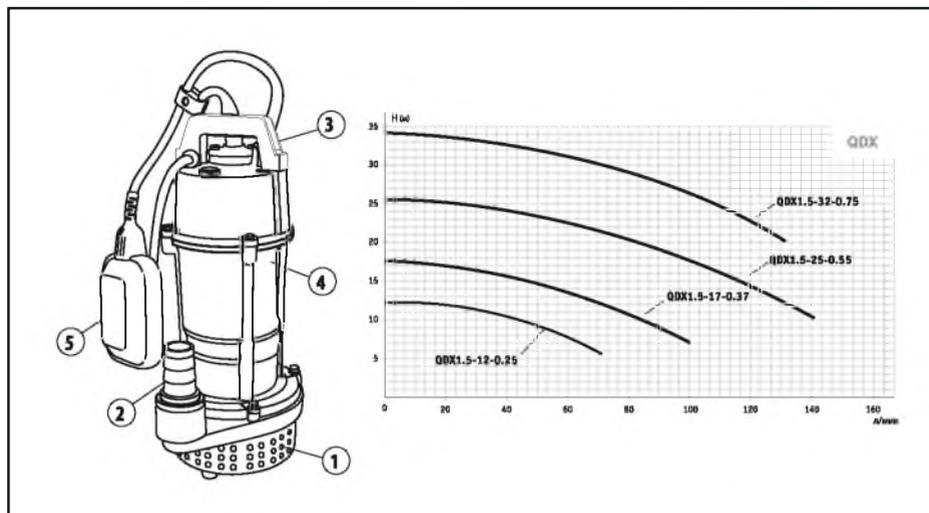
1. Впускное отверстие 2. Выпускное отверстие 3. Ручка для транспортировки
