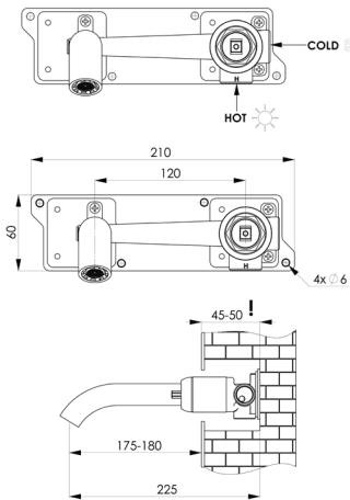
RU. Подготовьте нишу для монтажа смесителя. Глубина ниши должна составлять от 45 мм до 50 мм, включая толщину плитки (!). После окончательной установки смесителя его корпус должен находиться в подготовленной нише (см. схему).
