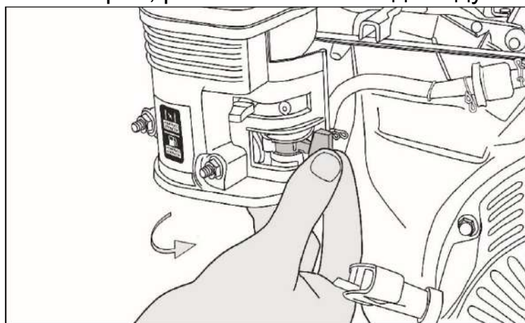
Рис. 34. Открытие топливного крана
