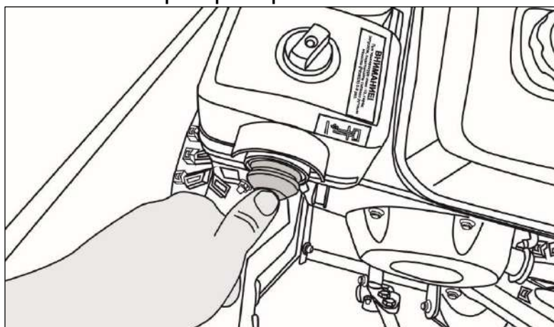
Рис. 37. Накачка топлива в карбюратор.
