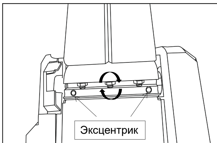
Рис.3. Замена режущего ножа
